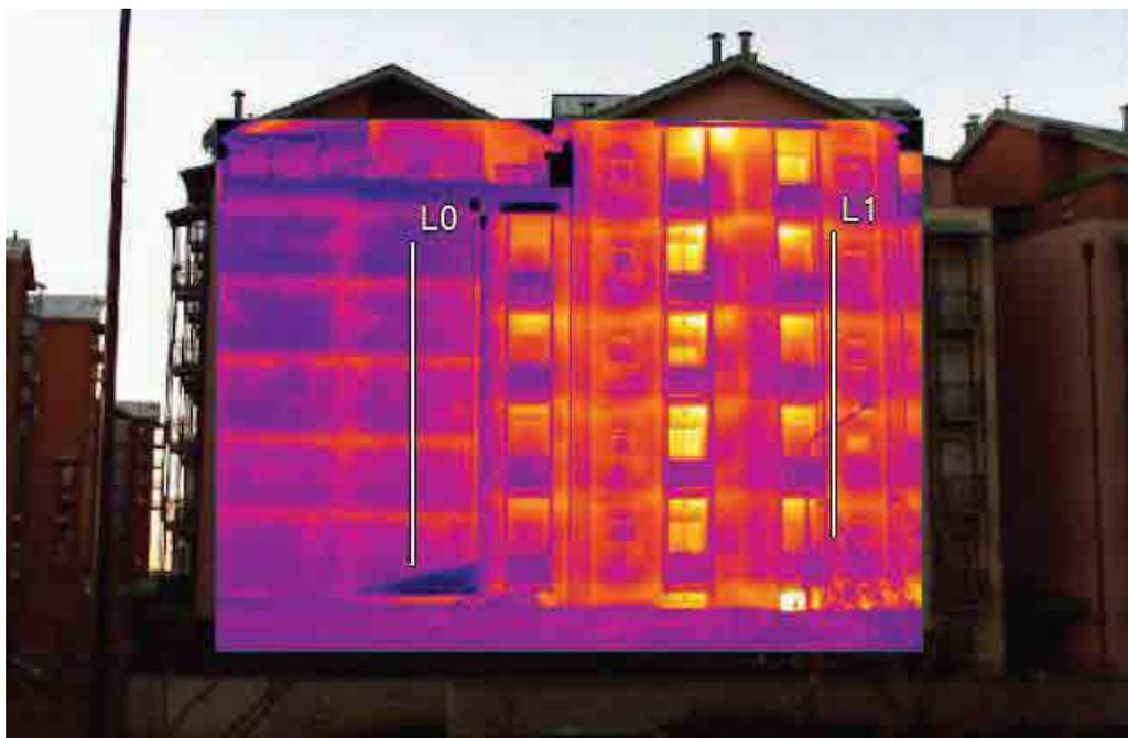
L'andamento delle temperature misurate, con gradienti termici superiori a 3-4°C, evidenzia lo scarso isolamento termico delle superfici opache esterne.
