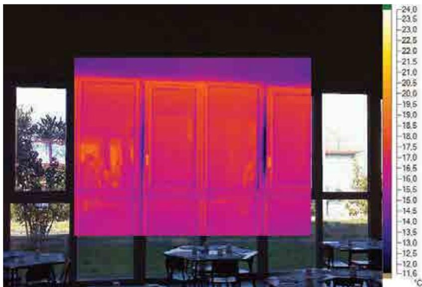
In questa immagine si evidenzia il pessimo stato di conservazione delle tenute dei serramenti, in quanto si registrano temperature prossime (11,5°C) a quella esterna (10°C) con temperatura ambiente di 21°C.
