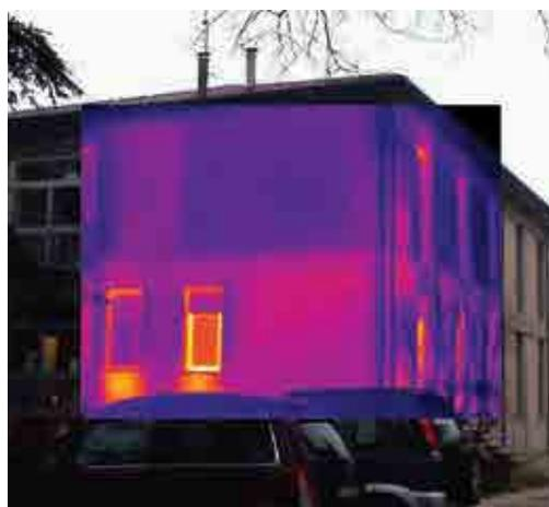
*Differenze di temperatura tra locali riscaldati e non riscaldati*
