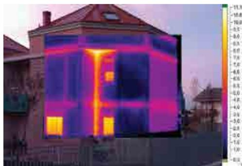
L'analisi infrarossi mette in evidenza lo scarso isolamento delle superfici opache esterne con differenze di temperatura superiori a 4°C.
